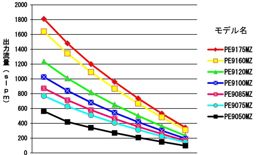
(注) 入力圧力 : 0.9MPa/出力圧力 : 0.2MPa
